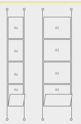
Materiali: Tasche in plexiglass antiurto trasparenti. Cavo in acciaio inox e accessori murali con parti in alluminio anodizzato e materiale sintetico.
