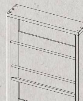
Wood Rack Wall è disponibile nelle dimensioni sopra indicate: altezza 1380 mm, larghezza 330 mm, profondità 80 mm. Il montaggio è molto semplice in quanto tutte le componenti della struttura si assemblano ad incastro.
